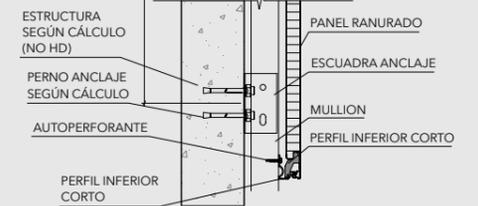
Este producto se instala sin fijaciones a la vista, con un sistema de perfilera oculta que permite un fácil montaje.
