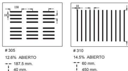
Nota: Estos tipos de perforaciones y ranuras pueden variar según los requerimientos del proyecto. Contactar Departamento Técnico HunterDouglas.
