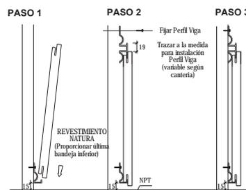
Nota: La instalación se realiza de abajo hacia arriba, de esta forma se logra una instalación más rápida
